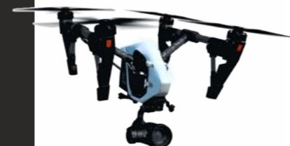
1. Беспилотный летательный аппарат (БПЛА) - это искусственный мобильный объект (летательный аппарат), как правило, многоразового использования, не имеющий на борту экипажа (человека –пилота) и способный самостоятельно целенаправленно перемещаться в воздухе для выполнения различных функций в автономном режиме (с помощью собственной управляющей программы) или посредством дистанционного управления, осуществляемого человеком-оператором со стационарного или мобильного пульта управления.
